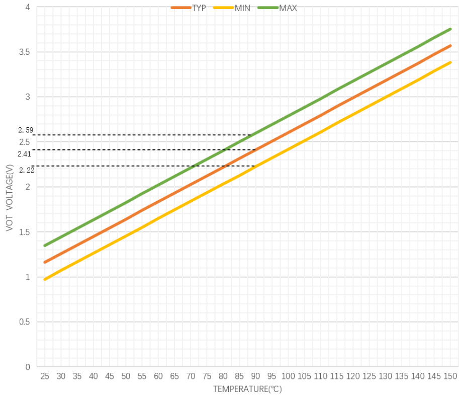
图12. 温度输出电压 Figure12. Temperature Output Voltage
