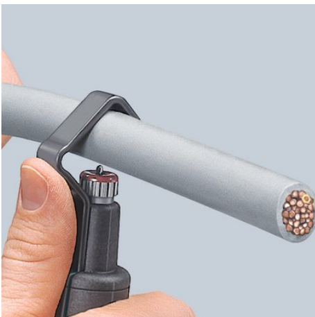
Установка инструмента для разреза по окружности
