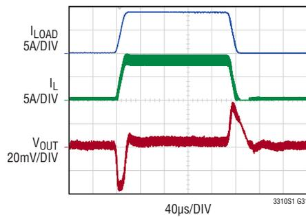
3.3V<sub>IN</sub> TO 1.2V<sub>OUT</sub>, 2MHz
