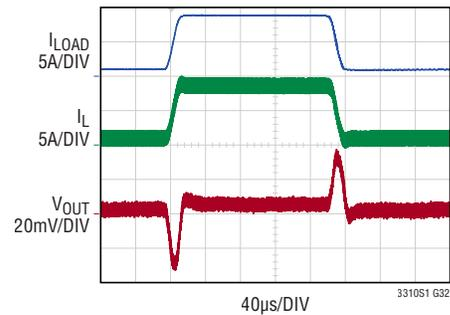
3.3V<sub>IN</sub> TO 1.2V<sub>OUT</sub>, 2MHz
