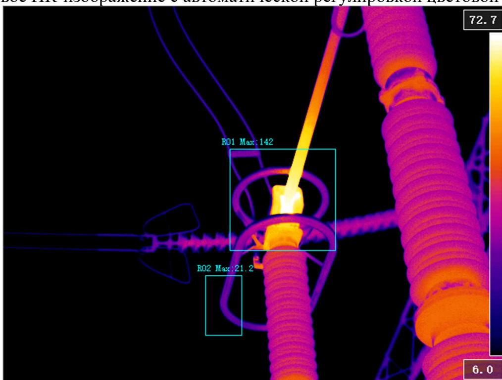
Тепловое ИК-изображение с ручной регулировкой цветовой шкалы
