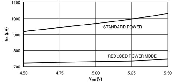
**SUPPLY CURRENT VS. SUPPLY VOLTAGE**
