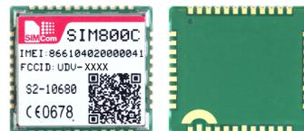
SIMCom Wireless Solutions представляет миниатюрный GSM/GPRS модуль сотовой связи SIM800C размером всего 15.7ммX17.6ммX2.3мм в форм-факторе LCC. Модуль SIM800C - это полнофункциональный четырехдиапазонный (Quad-Band) GSM/GPRS модуль с поддержкой интерфейса Bluetooth 3.0.
