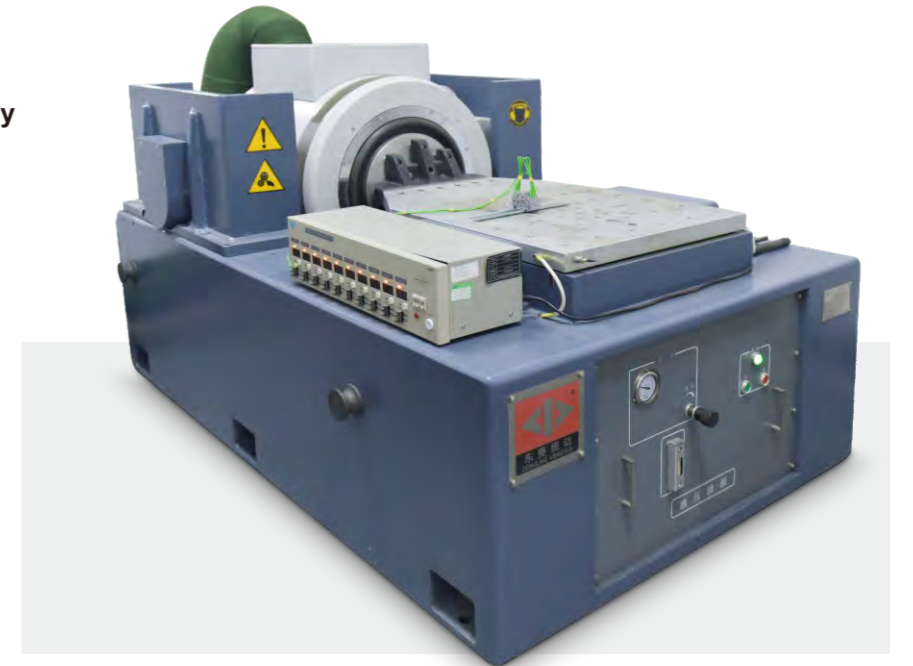
Испытательная установка для вибрационных нагрузок
