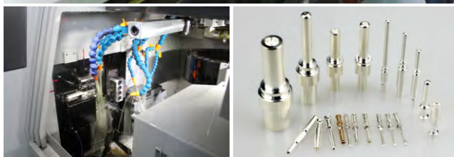
Станок по производству контактов кручением
