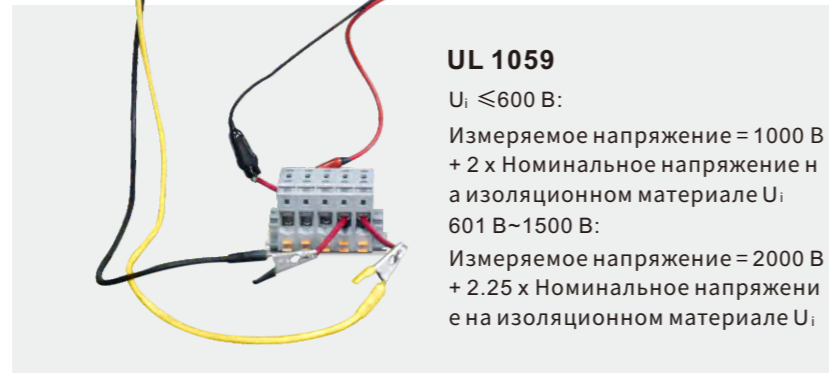
Испытание импульсным напряжением
