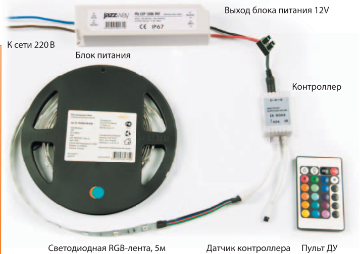
СХЕМА 5. Подключение многоцветной (RGB) светодиодной ленты
