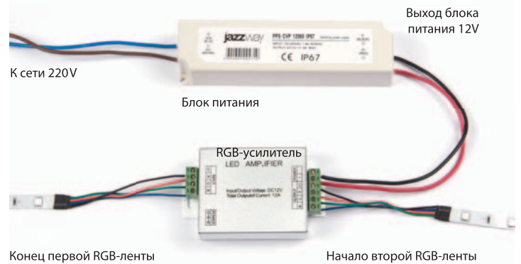
СХЕМА 6. Подключение усилителя мощности
