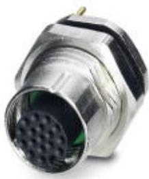
Встраиваемый соединитель для датчика/исп. устр-ва, гнездовая часть, 17-контактн. с экранир. контактом, M12-SPEEDCON, с мех. ключом А, монтаж на задней панели / резьбовое крепление M16, с прямыми выводами под пайку
