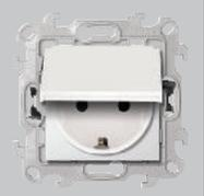
2420448 | -030 -031 -033 -038 | Розетка с заземлением Schuko со шторками, 2P+E, с крышкой и пылевлагозащитой IP44 | Push&Go | 16 А | 250 В~     | Безвинтовое |
