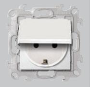
2450448 | -030 -031 -033 -038 | Розетка с заземлением Schuko со шторками, 2P+E, с крышкой и пылевлагозащитой IP44 | Монтажные лапки | 16 А | 250 В~     | Безвинтовое |
