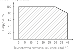
Рис. 1. Максимальная допустимая нагрузка, % от мощности источника
