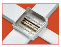
Используется с коробами 100x80, 120x80, 150x60, 150x80, 200x60 и 200x80 мм. На дне коробок SDN могут быть установлены клеммники благодаря возможности крепления ко дну DIN-рейки
