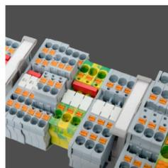
Два ряда шунтирования позволяют объединять двухконтактными перемычками любое количество клемм. С помощью перемычек на 2-10 выводов можно за один раз соединить до 50 клемм
