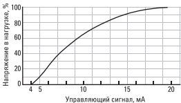
Рис. 4 Зависимость выходного напряжения от входного сигнала 4-20мА
