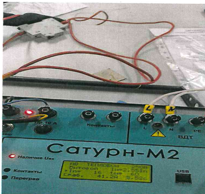
Проверка время-токовой характеристики, мгновенного расцепления и точного размыкания контактов
